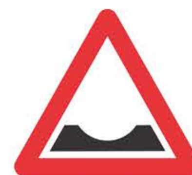
I-13 Neravan kolovoz (ulegnuće kolovoza)
