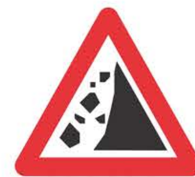
I-17 Odron kamena sa desne strane kolovoza
